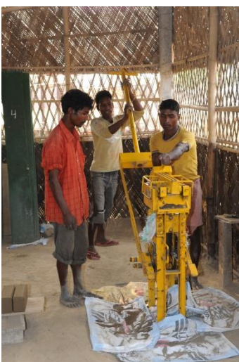
Statt Ziegel mit viel Holzkohle zu brennen, können wir sie auch umweltschonend herstellen. In Barpeta Road sollen Jugendliche zukünftig dieses und andere Handwerke lernen können.
